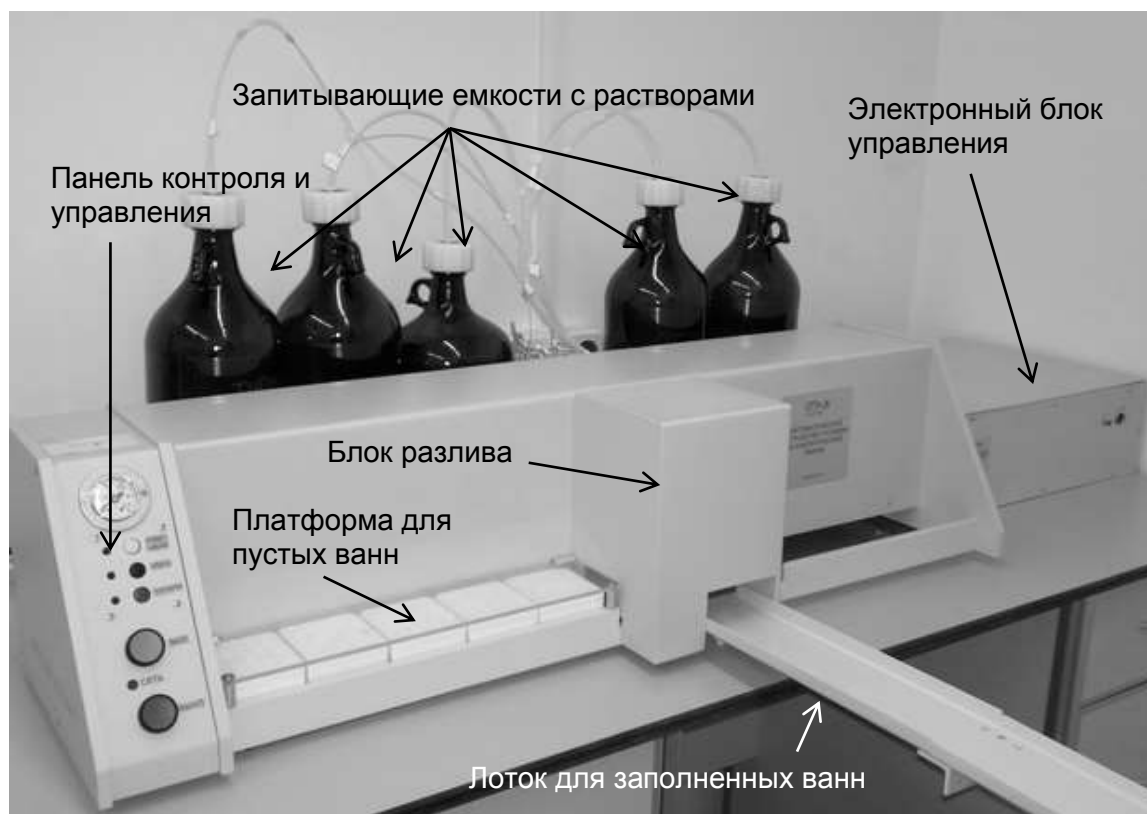
Рисунок 22 - Устройство для автоматического заполнения аналитических ванн «Ранар»
